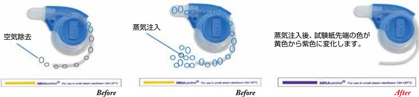
“メラコントロール”は、ISO11140-1のクラス2に準拠していて、日常の滅菌バリデーションを確認する為に使用するヘリックステストです。内部の空気除去が徹底的に行われ、蒸気が確実に行き渡っているか確認できます。メラコントロールのチューブ内径は2mm・全長は1.5mです。
