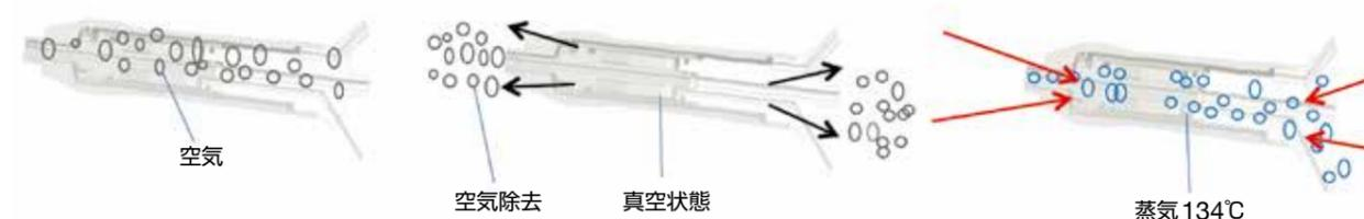
内腔残留空気が原因で、蒸気注入がブロックされています。
